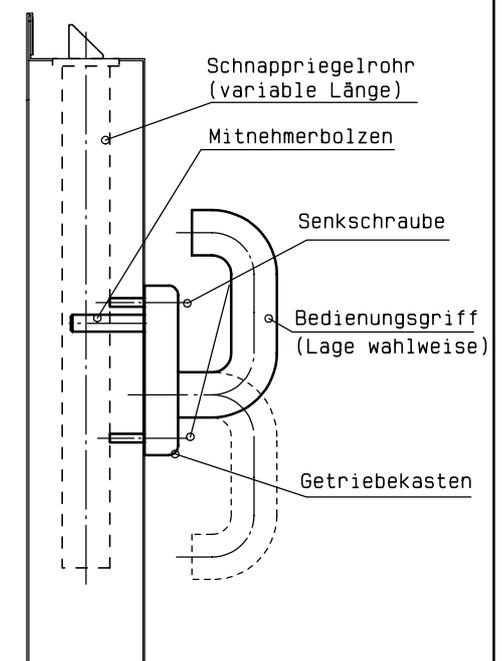
\*) Falztreibriegelschloss (vom Mittelanschlag aus bedienbar) ist bereits werkseitig montiert.
