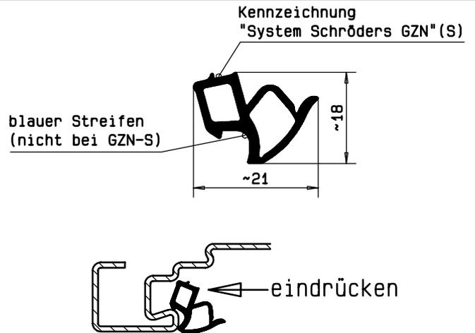
Die lose beiliegende Dichtungsprofile wird in die Zargennut eingedrückt. **nicht strecken!**
