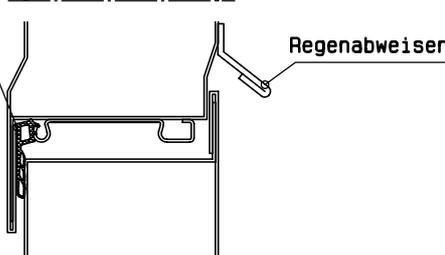
luftdicht bis Kl.4 (+- 600 Pa)
