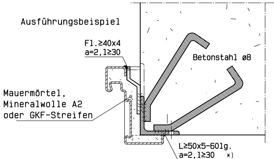
Diese Befestigung ist nur möglich, wenn die Ankerstücke bereits bei Erstellen der Wand einbetoniert / eingemauert werden.
